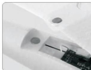
Da Sie sich für ein RTF Modell entschieden haben ist die Endmontage in wenigen Minuten erstellt. Stecken Sie die Tragfläche in den Rumpf, sie wird durch ein Magnet gehalten. Überprüfen sie alle Anlenkungen für Höhen und Seitenruder.
